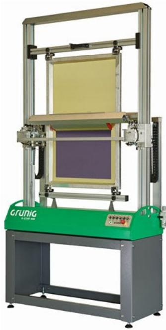
**Automatische Beschichtungsmaschine G-COAT 406**
