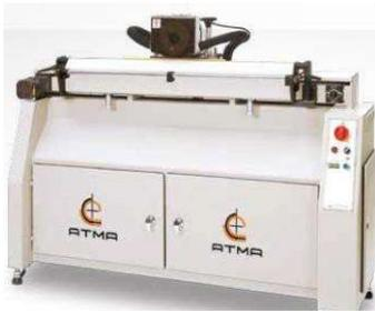
Vollautomatische Rakelschleifmaschine mit Lasererkennung für Rakellänge und Gummihöhe. Ausführung mit Speichermöglichkeit für mehrere Schleifprogramme, Doppel – Diamantschleifscheibe für den Grob- und den Feinschliff. Effektives Vakuumsystem für die Absaugung der Schleifpartikel.
