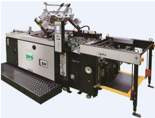
Die VITESSA XP57 ist die traditionelle Siebdruck - Stoppzylindermaschine von SPS. In Kombination mit dem Hinterkanten – Bogenanleger ist eine Druckgeschwindigkeit von 4.500 Bogen/h möglich. In Kombination mit dem Einzelbogen – Vorderkantenanleger, der speziell für empfindliche Kunststoff- und andere Materialien eingesetzt wird, beträgt die max. Produktionsleistung 2.500 Bogen/h.
