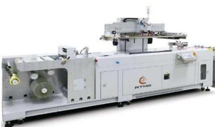
Die automatische Rollenflachbett-Siebdruckmaschine ist ausgestattet mit einer optischen Sensorbahnregistrierung die mit einer Genauigkeit von 0,1 mm und Geschwindigkeiten von 14 m/min arbeitet. Auf der Messe wird die Anlage gezeigt mit einer Abwickel- und Delaminierungseinheit, die Druckeinheit, eine Pufferstation und die Aufwickleinheit.
