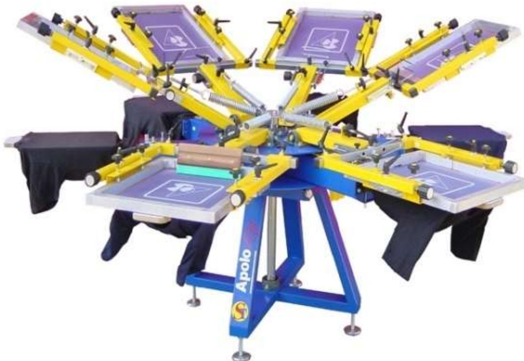
Eine bewährtes Textildruckkarussell ist das Modell **APOLO**. Mit dieser Anlage kannst Du alle möglichen Shirts, Mäntel, Mützen oder Regenschirme bedrucken. Das Motiv kann in einem Rahmen bis zu einem max. Format 590 x 800 mm platziert werden. Das Karussell ist ausbaufähig von 4 bis 12 Farben / Paletten.
