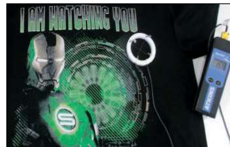
SM_35100-K Prüfen der Trockentemperatur
