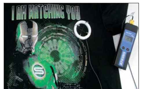
SM_35100-K Prüfen der Trockentemperatur
